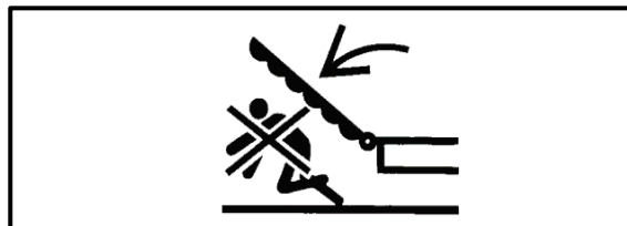
Abb 93. Está prohibido permanecer en la zona de viraje de la máquina - Existe peligro de lesiones
