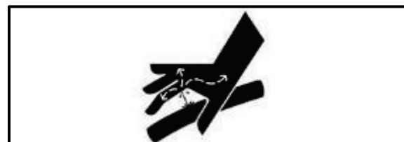
Abb 139. Peligro de inyección de fluido
