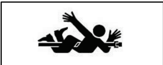
Abb 63. Peligro de atrapamiento y arrastre en árboles en rotación
