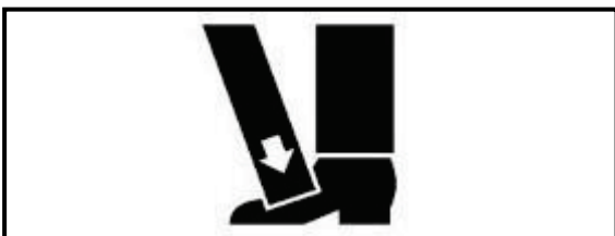
Abb 195. Peligro de aplastamiento de los pies
