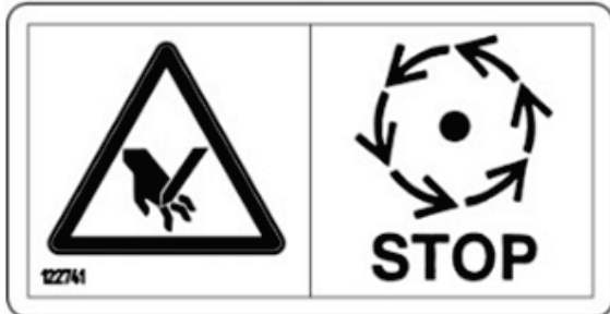
Abb 39. Esperar hasta que haya transcurrido el tiempo de inercia o se haya producido la parada
