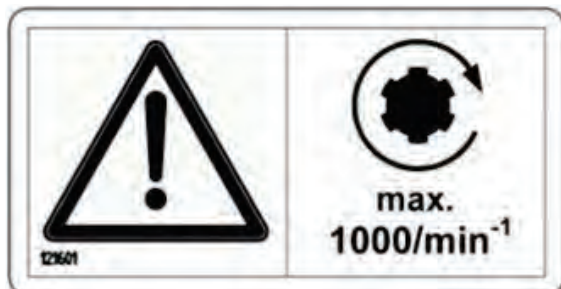
Abb 35. Número de revoluciones de accionamiento 1.000 R.P.M.
